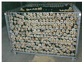
もみがらの容積を約 1/10 にまで圧縮！ メッシュパレットで保管可能（約 600 kg）
