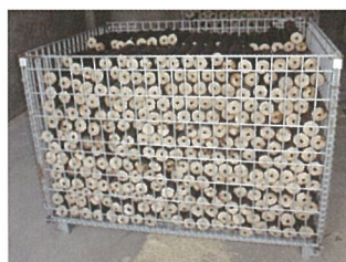
もみがらの容積を約 1/10 にまで圧縮！ メッシュパレットで保管可能（約 600 kg）
